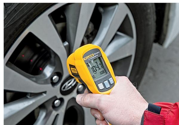
← Температуру тормозных дисков контролировали после каждого торможения.
